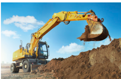
Déplacements de terre automatisés grâce à l'enregistrement de position intelligent de la flèche, du mât et de la pelle
