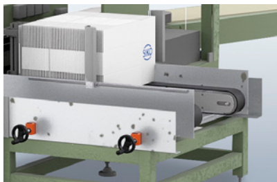
Réglage reproductible de redresseurs de cartons
