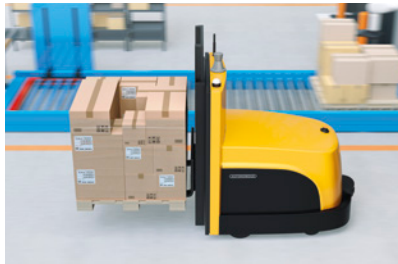
Enregistrement de la vitesse et du sens de marche sur les véhicules à guidage automatique (AGV/AGC) avec des codeurs rotatifs sans roulement innovants
