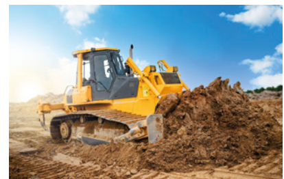
Des capteurs intégrés dans le vérin assurent un nivellement optimal et un positionnement automatisé de la lame sur les bulldozers à chenilles
